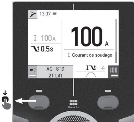
Appuyer sur le bouton-poussoir n°1 pour afficher les paramètres modifiables.
